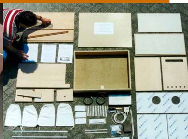
De onderdelen van een couveuse
