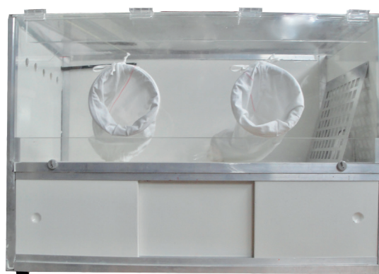
Prototype van de couveuse met nieuw plaatmateriaal. Veel lichter in gewicht, maar nog niet productierijp.
